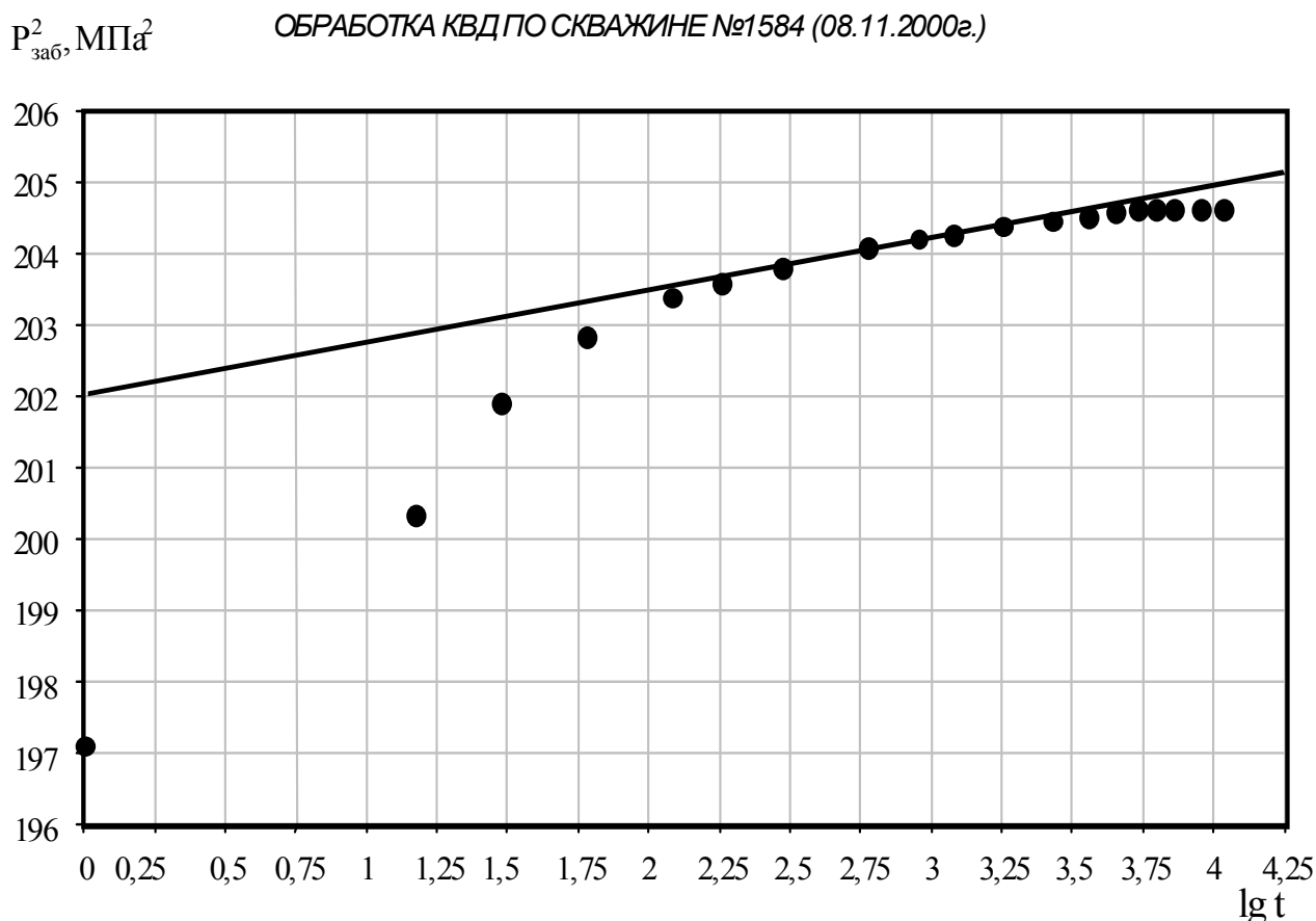
Рисунок 9.2 – Кривая восстановления давления без аномалий
